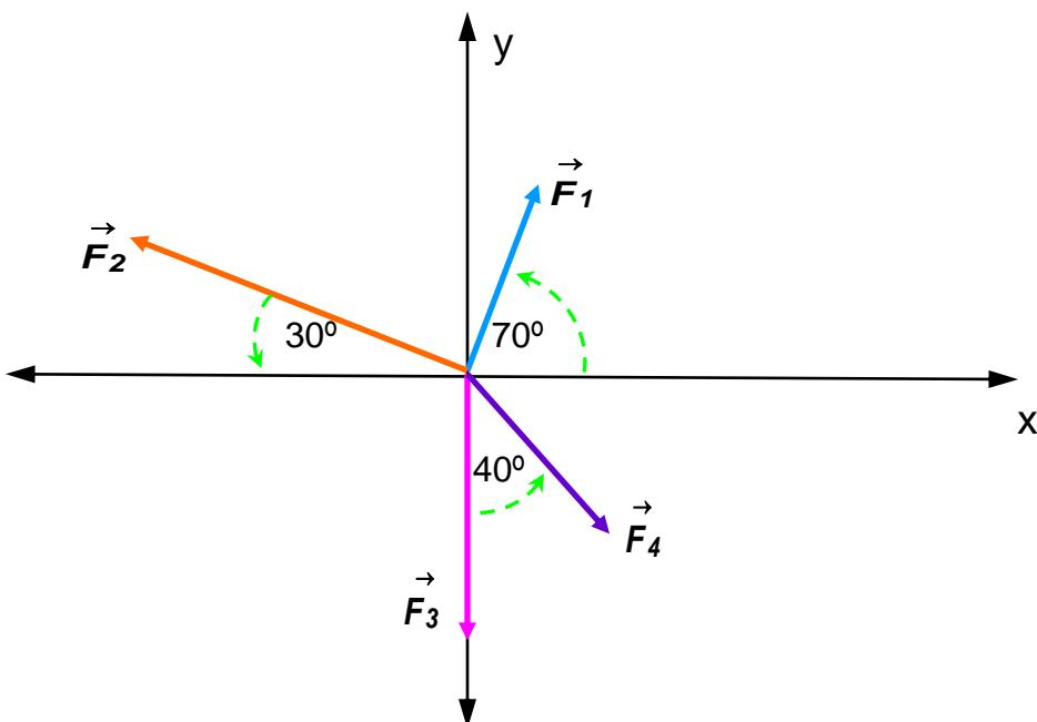
**Nº 2** Datos:  $\vec{F_1} = 500 \text{ N}$  ;  $\vec{F_2} = 300 \text{ N}$  ;  $\vec{F_3} = 400 \text{ N}$  ;  $\vec{F_4} = 300 \text{ N}$
