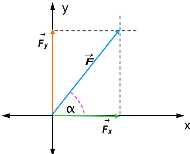
El módulo de las 2 nuevas fuerzas ( $\vec{F}_x$  y  $\vec{F}_y$ ) se puede obtener a partir de la definición del seno y del coseno:  $\text{sen } \hat{\alpha} = \frac{CO}{H}$  y  $\cos \hat{\alpha} = \frac{CA}{H}$
